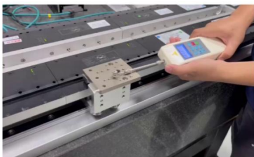
图 3 峰值推力测试
